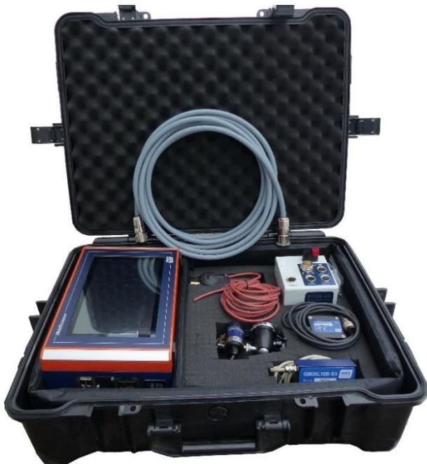
Der WeldScanner Validator validiert Lichtbogen-Schweißgeräte sämtlicher Hersteller gemäß der europäischen Norm EN 50504. Es bietet außerdem die volle Funktionalität des WeldScanners.
