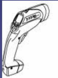
Wird zur Prozessführung eingesetzt, allerdings sind die Ergebnisse teilweise nicht zuverlässig. Da kein homogenes Wärmefeld vorliegt, ist die gemessene Temperatur vom Ort und der Temperaturverteilung in der Schweißnaht stark abhängig.
