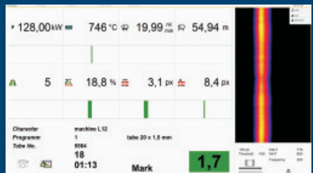
Arbeitsmonitor beim Laserschweißen mit automatischer Qualitätsbewertung
