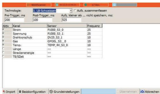
Auswahl der **Technologie** und der **Messkanäle**.
