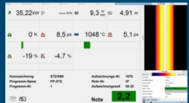
Benutzeroberfläche mit automatischer Schweißnahtauswertung
